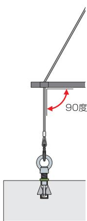
垂直吊りには必ず天秤を使用し、Vハンガー・ワイヤー・吊り上げ治具が垂直になるように天秤の幅を調整して下さい。
